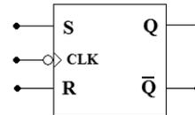
I - O *clock* é ativado na transição do nível lógico 1 para 0 devido à presença da inversora.
