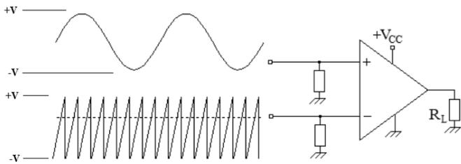
O circuito em questão executa a função de um comparador com resistores de entrada de mesmo valor. O sinal desenvolvido na carga (saída do amplificador operacional) é
